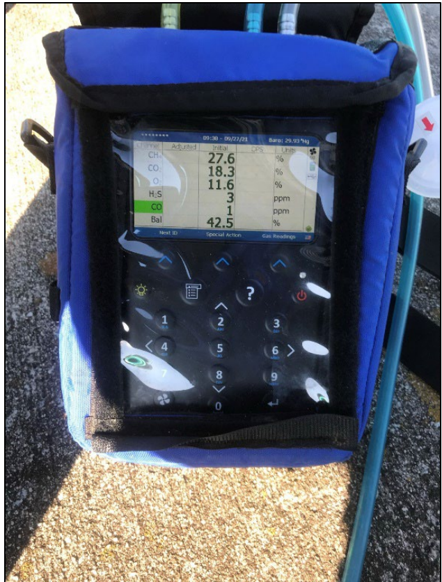
Landfill Gas Meter
